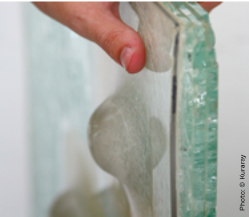
• Trosifol® Spallshield® CPET impact test
