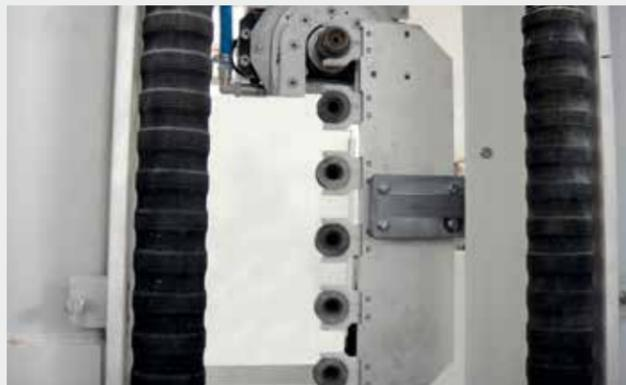
Unità di foratura posteriore. Il mandrino posteriore è dedicato alla foratura del vetro e può raggiungere qualsiasi zona della lastra senza nessuna limitazione. Il foratore permette di utilizzare foretti fino a 50mm di diametro, è inoltre dotato di un sistema di raffreddamento direttamente integrato nel pressore di contrasto lastra. Il mandrino dispone di una magazzino utensili dedicato che ospita 6 diversi utensili ma può essere ampliato fino a 20 posizioni
