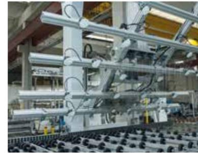
Sistema di manipolazione automatica delle lastre di vetro
