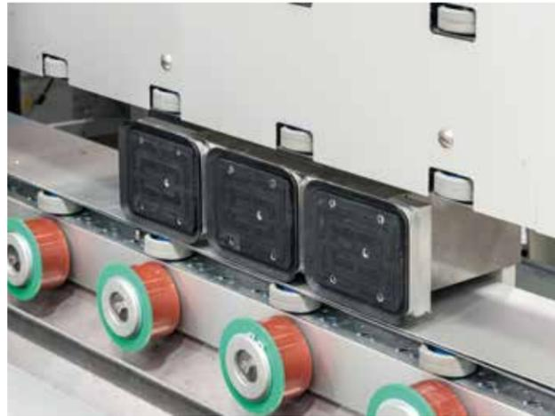
Il fermo di riferimento è montato su un asse controllato che garantisce la massima precisione pur non pinzando il vetro. In questo modo è garantita la possibilità di lavorare vetri con basso emissivo.
