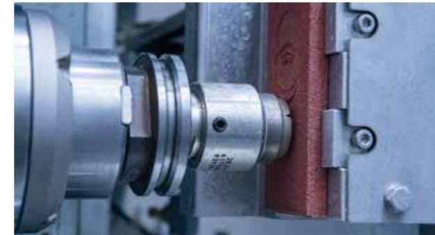
Per assicurare la massima precisione di lavorazione la macchina dispone di un sistema di misurazione automatica dei foretti. In questo modo l'operatore è sgravato dal compito di dover verificare l'usura degli utensili. E' inoltre possibile ravvivare i foretti in modo completamente automatico seguendo una frequenza stabilita. Questo sistema, completamente automatico, permette di avere in totale sicurezza utensili che lavorano sempre al massimo delle performance.
