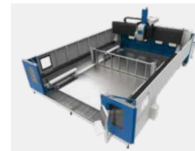
Versione con doppio piano di lavoro. La macchina può essere configurata per lavorare anche in modalità pendolare ed in totale sicurezza per l'operatore. All'occorrenza rimuovendo la paratia che separa le due zone è possibile lavorare con una tavola con maggiori dimensioni.
