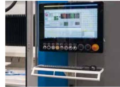
Consolle integrata alla macchina, lo schermo da 21.5" con funzione touch permette di sfruttare appieno la nuova interfaccia operatore. L'operatore viene costantemente guidato nelle operazioni più comuni per il funzionamento della macchina.
