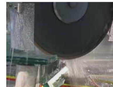
Grazie alla potenza del mandrino è possibile montare dischi da taglio per eliminare il materiale in eccesso. Particolarmente indicato quando si elaborano geometrie complesse su vetri stratificati.
