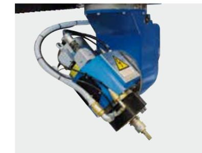
La testa 5 assi permette di eseguire ogni tipo di lavorazione senza limitazioni. Si possono eseguire lavorazioni di bisellatura o molatura a tazza senza ricorrere a nessun aggregato.
