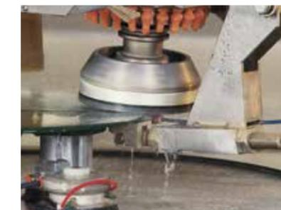
N.T.S. (Not Template System) è il rivoluzionario sistema che permette di eseguire bisellature su vetri sottili senza dover ricorrere alla creazione di una dima. Un supporto solido alla testa di lavorazione sostiene il vetro durante la lavorazione di bisellatura, in questo modo il risultato finale è un lavoro uniforme lungo tutta la lastra.
