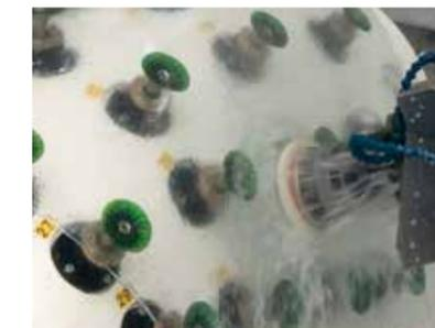
Ventosa pop up per la lavorazione di vetri curvi. Utilizzando specifiche dime è possibile lavorare vetri curvi di spessore sottile. La macchina guida l'operatore nel posizionamento delle ventose e del pezzo.
