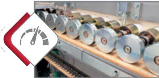
Resistenze modulari con sonde di temperatura
