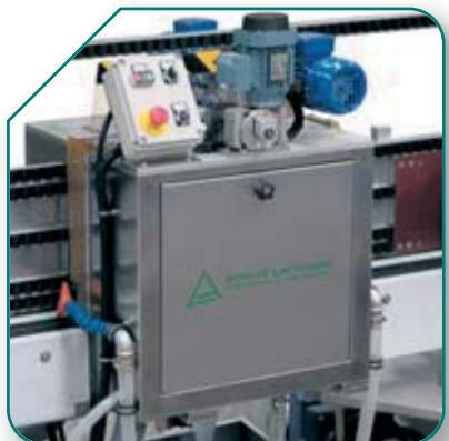
**Lavatrice applicata sul braccio di uscita di molatrici e bisellatrici**, permette di ottenere la completa pulizia e asciugatura dei bordi lavorati delle lastre.
