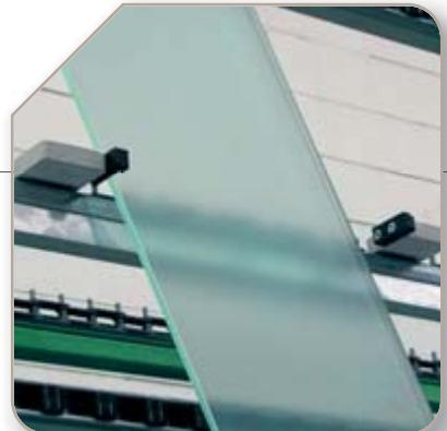
**PAR-AL:** dispositivo per la lavorazione di vetri inclinati a **forma di parallelogramma**.
