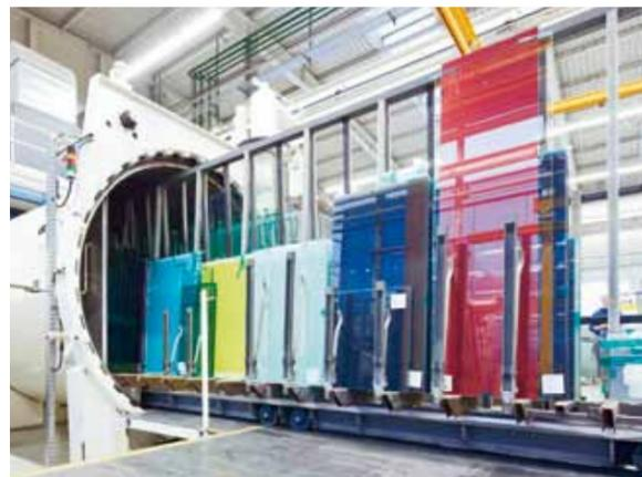
» Autoklav, der mit Verbund-sicherheitsglas beladen wird.
